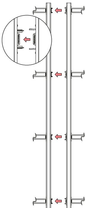
Insérer les vis tête fraisée et régler à l'angle souhaité. Puis, serrer les vis avec une clé hexagonale de 3mm.
