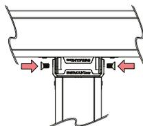
Ajuster le rail horizontal dans l'angle souhaité, puis serrer les vis tête fraisée avec une clé hexagonale de 3mm.
